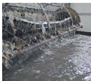
Мойка пластиковых хлопьев
