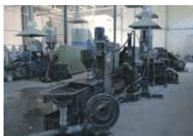
Фрагмент производственной линии по переработке пленки во вторичную гранулу
