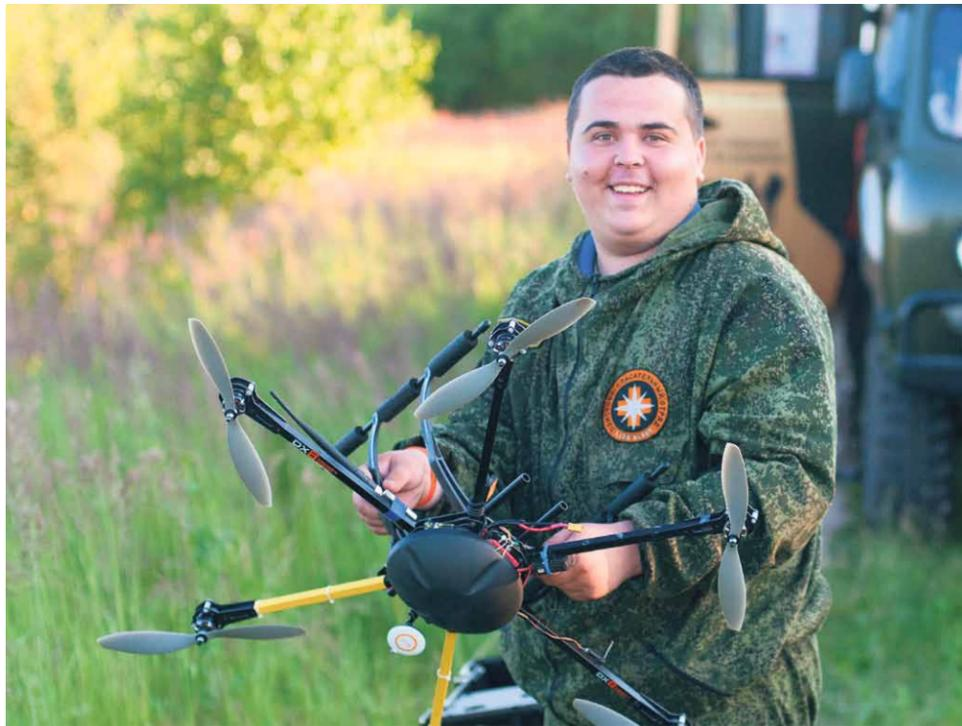
В поисках людей используется гексокоптер – летательный аппарат, снабженный камерой и передающий картинку на мониторы спасателей
